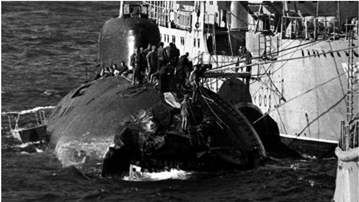
Подлодка К-314 после всплытия. Видны повреждения легкого корпуса. Фото Vrk.name
