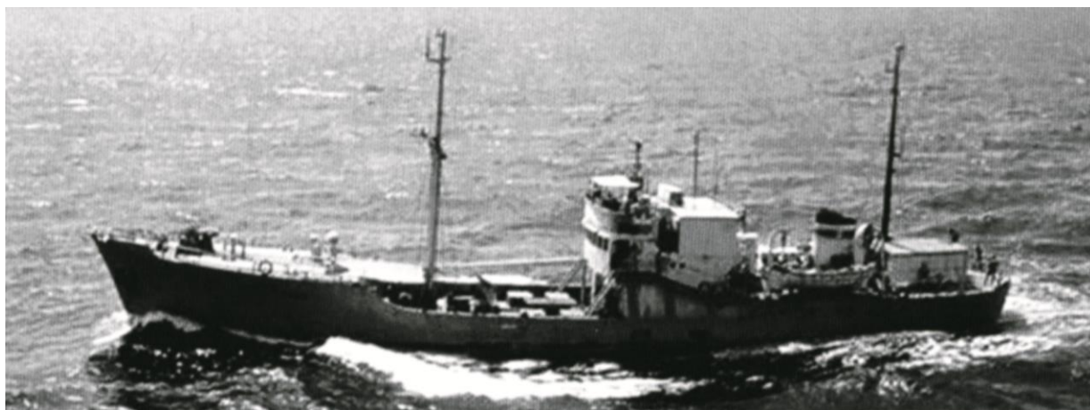
Малый разведывательный корабль «Протрактор» Тип «Тунцелов»: водоизмещение 1050 тонн, скорость хода 14 узлов
