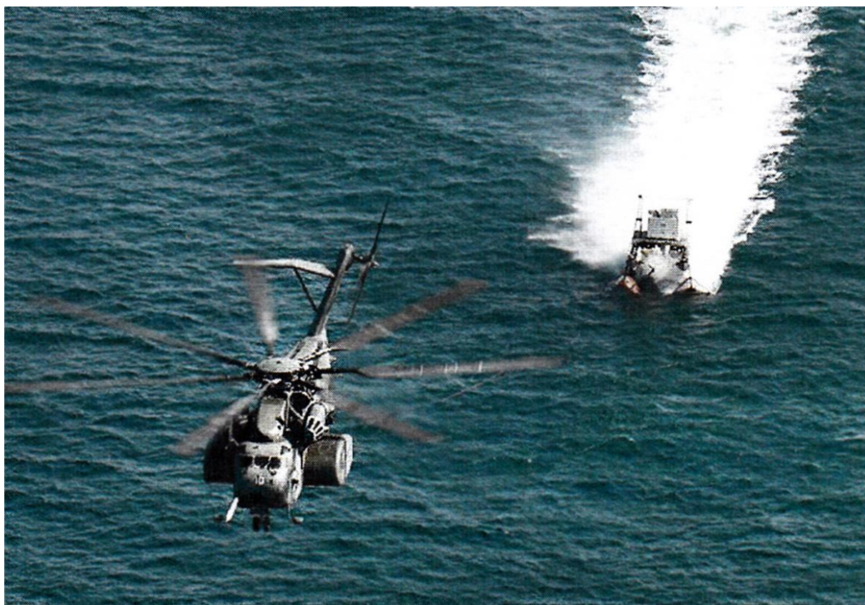
Буксировка вертолетом-тральщиком RH-53D неконтактного трала Mk-105
