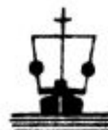
Машины работают средним ходом
