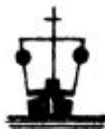
Машины работают малым ходом
