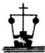
Машины работают самым малым ходом
